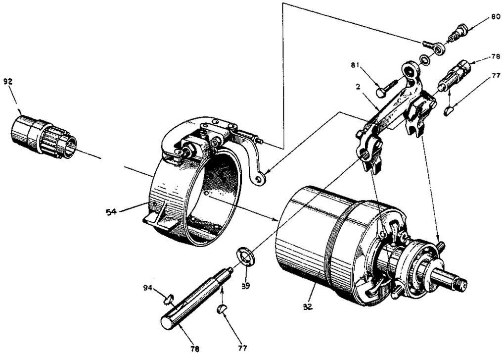
TOGGLE OPERATED REVERSE BAND ASSEMBLY STANDARD
