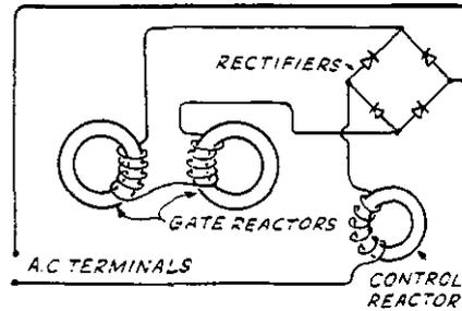
Fig. 4.E -- Control Circuit
